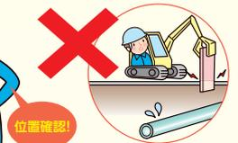
深さ1.5m以上の布掘りまたはつぼ掘りを行い、ガス管の位置を確認してください。
